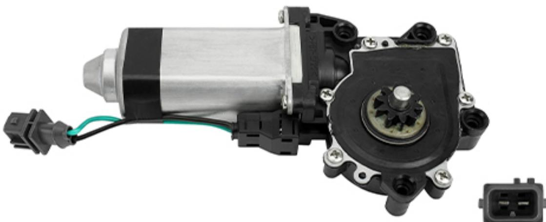
Электродвигатель стеклоподъемника представляет собой электродвигатель, который приводится в действие кнопкой на панели управления в салоне; он используется для подъема или опускания оконных стекол независимо друг от друга или для их остановки в любом положении.
