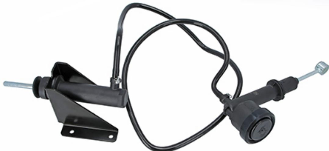
При нажатии на педаль сцепления приведенный в движение поршень создает давление в главном цилиндре сцепления, которое затем передается через гидравлическую линию в рабочий цилиндр. Отсюда давление передается на механизм расцепления, который открывает сцепление и тем самым прерывает передачу мощности от двигателя на трансмиссию.
