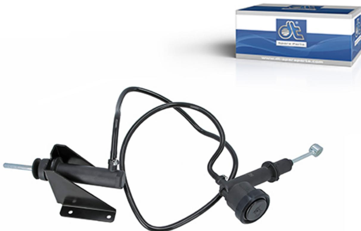
При нажатии на педаль сцепления приведенный в движение поршень создает давление в главном цилиндре сцепления, которое затем передается через гидравлическую линию в рабочий цилиндр. Отсюда давление передается на механизм расцепления, который открывает сцепление и тем самым прерывает передачу мощности от двигателя на трансмиссию.&nbsp;
