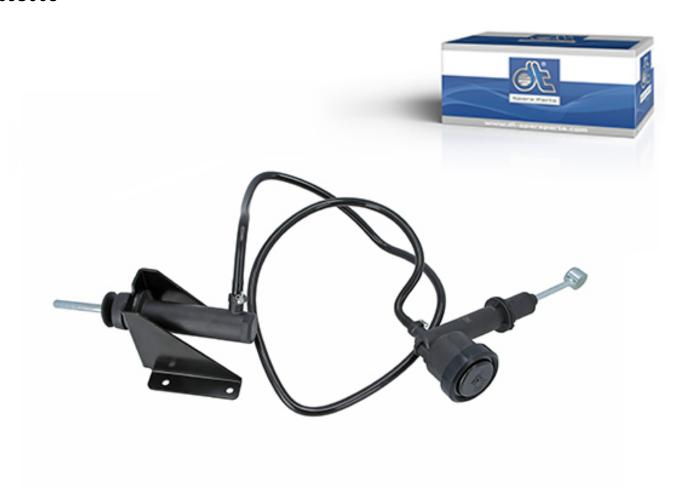
При нажатии на педаль сцепления приведенный в движение поршень создает давление в главном цилиндре сцепления, которое затем передается через гидравлическую линию в рабочий цилиндр. Отсюда давление передается на механизм расцепления, который открывает сцепление и тем самым прерывает передачу мощности от двигателя на трансмиссию.
