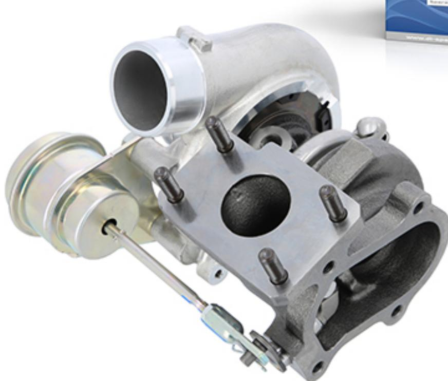
Турбонагнетатель с приводом от выхлопной системы двигателя состоит из двух частей: одной турбины и одного компрессора, размещенных на одном валу. Компрессор нагнетает воздух, который сперва проходит через воздухоохладитель для охлаждения, а затем при давлении до 2 бар подается в камеру сгорания.
