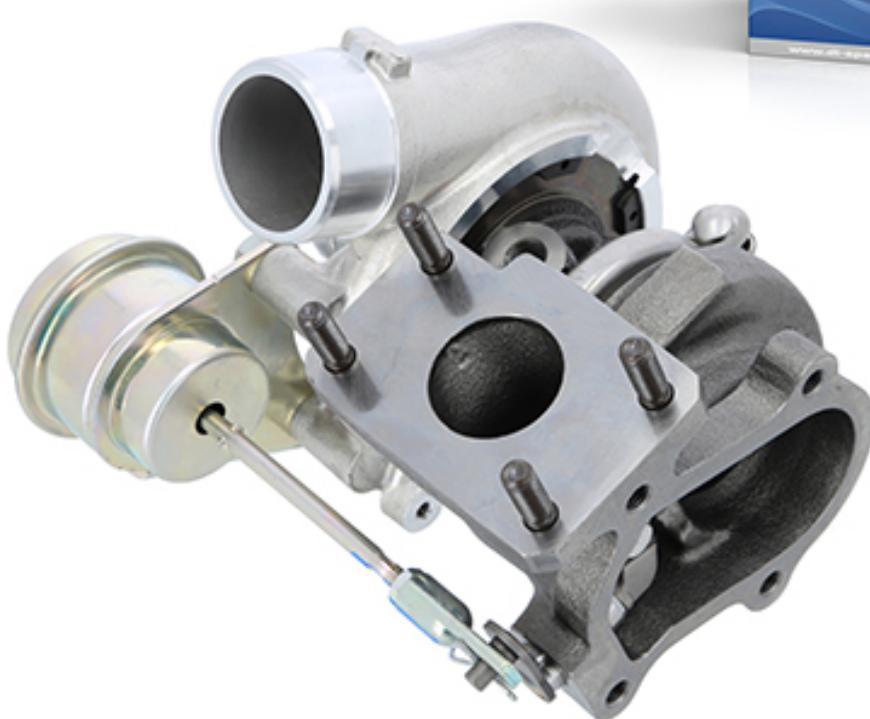
Турбонагнетатель с приводом от выхлопной системы двигателя состоит из двух частей: одной турбины и одного компрессора, размещенных на одном валу. Компрессор нагнетает воздух, который сперва проходит через воздухоохладитель для охлаждения, а затем при давлении до 2 бар подается в камеру сгорания.
