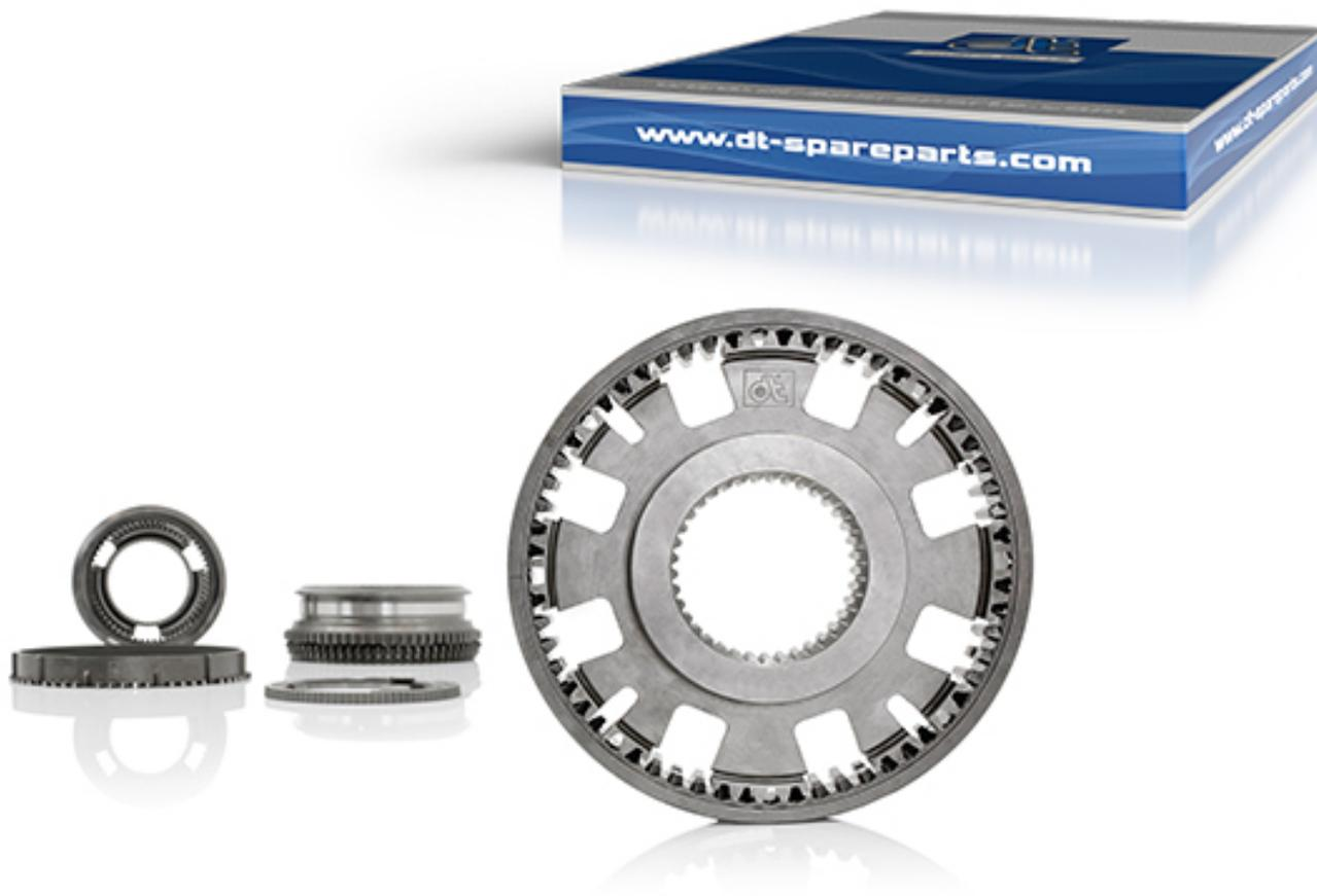
Синхронные шестерни образуют переход между шестерней передачи и муфтой переключения. Путем трения они приводят обе шестерни необходимой передачи к одинаковой частоте вращения, что позволяет включать передачу без перегазовки.
