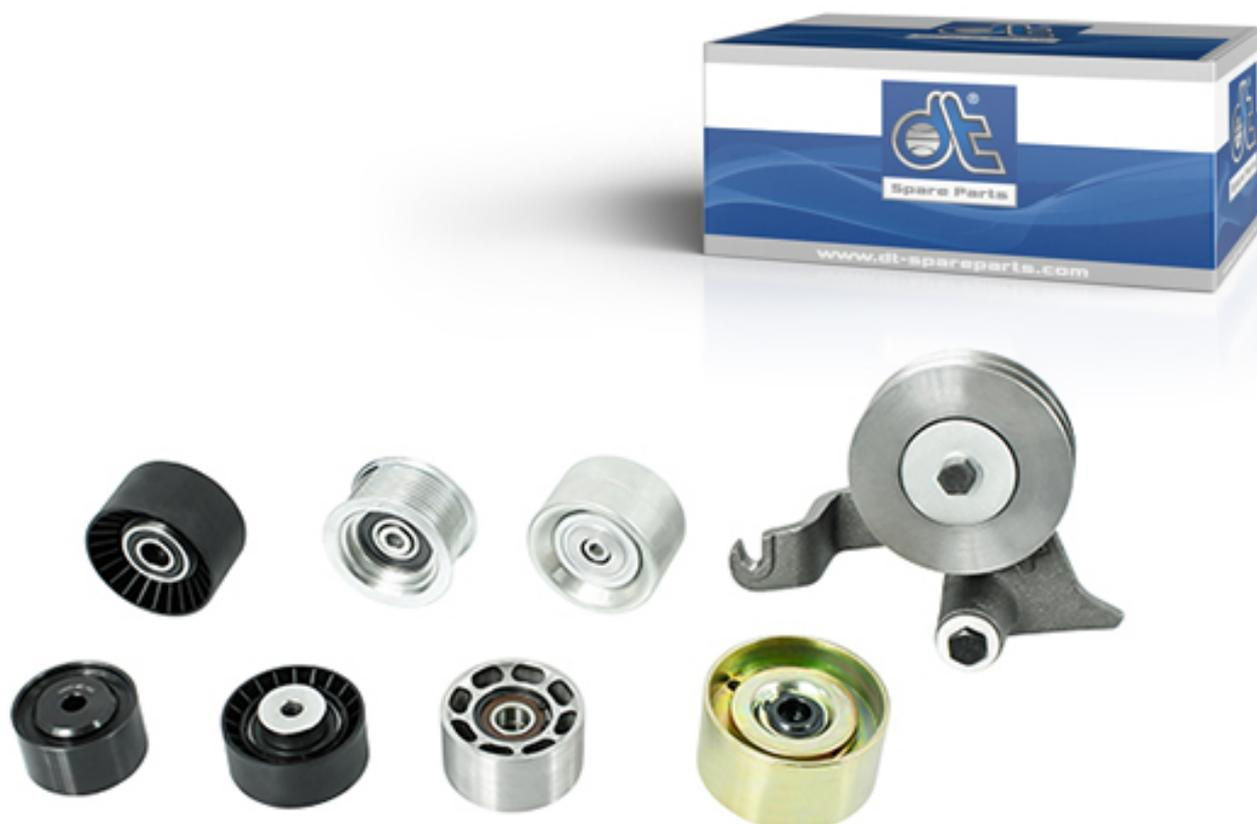
Натяжные ролики обеспечивают точность управления и постоянное натяжение ремня в ременном приводе. Они могут быть жестко установлены или скомбинированы с крепежными элементами для образования эластичного устройства для натяжения ремня. Натяжные ролики увеличивают угол охвата ременного привода и передают большее усилие. Они позволяют изменять направление вращения подключенных агрегатов. Вместе с устройством для натяжения ремня они компенсируют удлинение ремня, обусловленное эксплуатацией.
