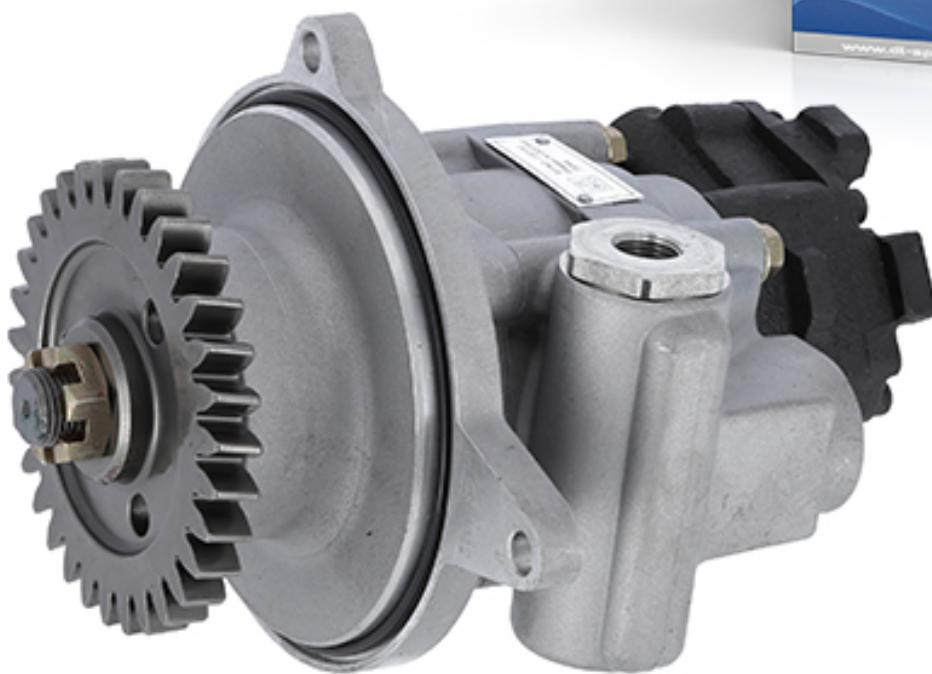
Насос гидроусилителя руля 2.53183 вырабатывает гидравлическое масло, необходимое для обеспечения легкости рулевого управления транспортным средством, и подает его к рулевому механизму. Встроенный редуктор обеспечивает бесперебойную работу привода, а подключенный тандемный насос подает топливо из бака на насос впрыска.
