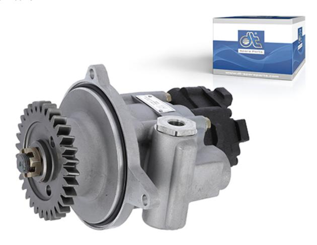
Насос гидроусилителя руля 2.53183 вырабатывает гидравлическое масло, необходимое для обеспечения легкости рулевого управления транспортным средством, и подает его к рулевому механизму. Встроенный редуктор обеспечивает бесперебойную работу привода, а подключенный тандемный насос подает топливо из бака на насос впрыска.
