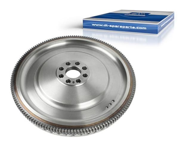
Маховик находится на коленчатом валу со стороны отбора мощности. Он служит для соединения двигателя и сцепления. Маховик придает большой плавный ход в двигателе. За счет вращательных движений коленчатого вала маховик может накапливать кинетическую энергию. Благодаря своей инерции он продолжает вращаться даже тогда, когда в определенные моменты двигатель не передает энергию привода.
