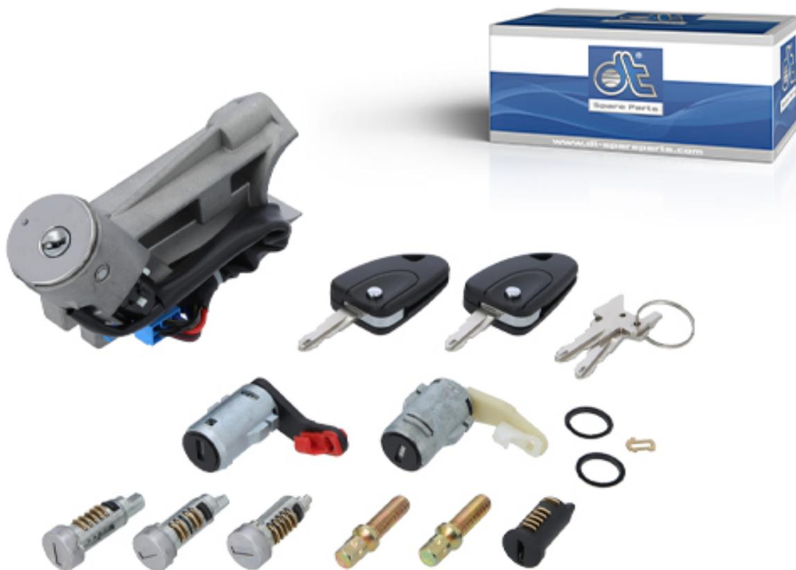
Цилиндры блокировки используются для приведения в действие системы блокировки исключительно с помощью подходящей сопряженной детали.
