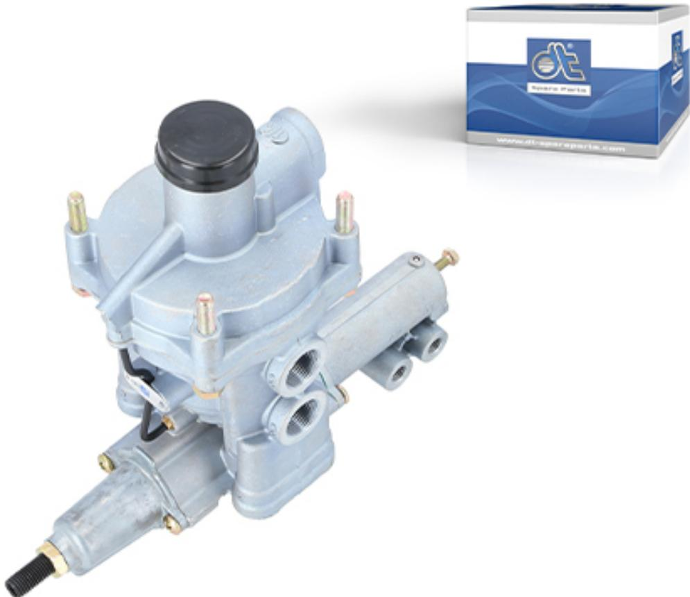
Задача автоматического регулятора тормозного усилия, зависимого от нагрузки, состоит в том, чтобы сделать тормозной эффект грузового автомобиля зависимым от степени загрузки транспортного средства. При большой нагрузке тормоза действуют сильнее, а при меньшей нагрузке эффект торможения снижается. Это снижает ненужный износ и предотвращает блокировку колес.
