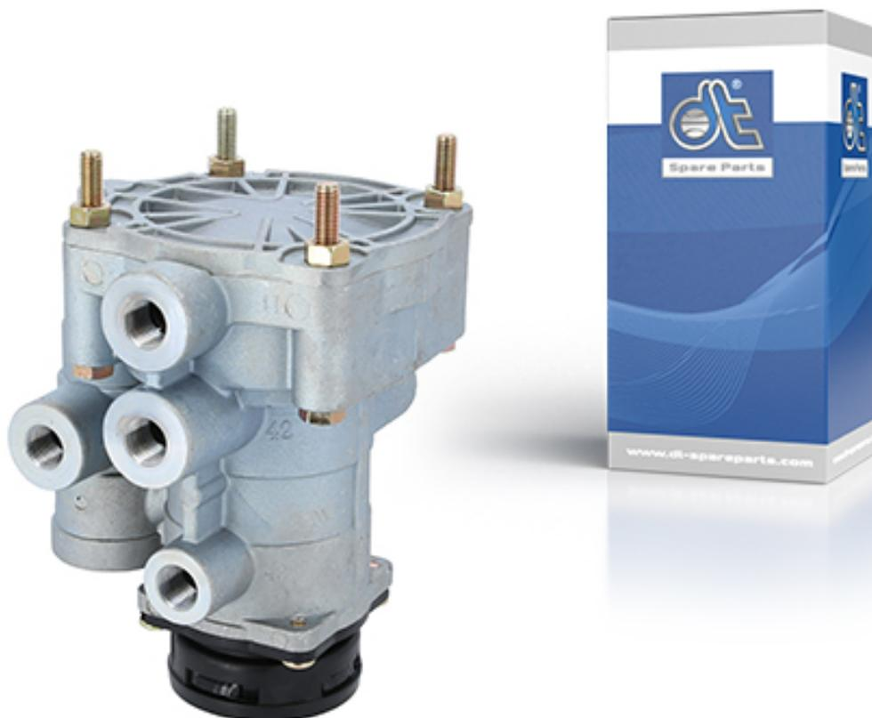
Управляющий клапан прицепа в буксирующем транспортном средстве обеспечивает тормозную систему прицепа сжатым воздухом. Он также регулирует тормозную систему прицепа посредством основной тормозной системы буксирующего транспортного средства, а также посредством парковочного и вспомогательного тормозного клапана.
