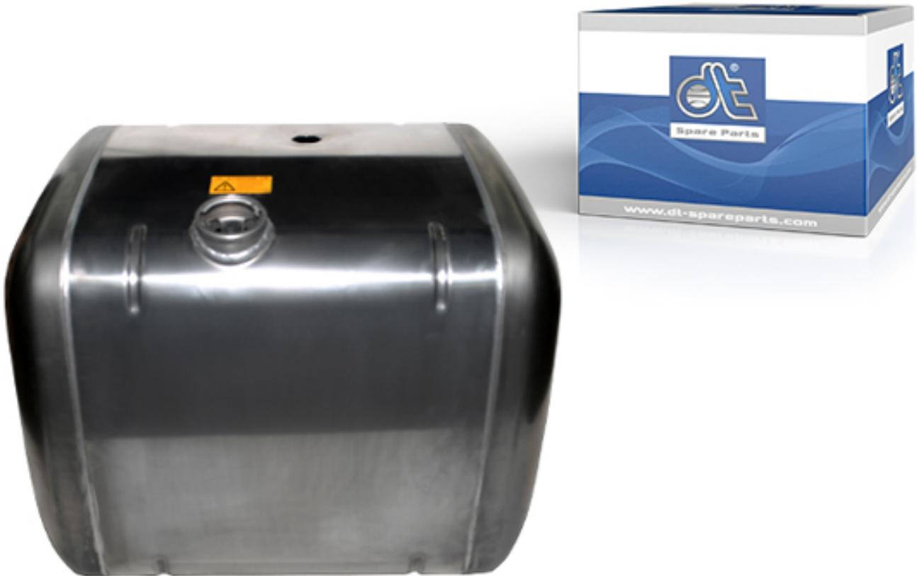
O diesel necessário para operar o motor é armazenado no tanque de combustível. Para economizar peso, o tanque é feito de alumínio e, no caso do 4.68877, tem um volume de 400 litros. É reabastecido através de um bocal e tem uma válvula de ventilação através da qual o ar preso e em excesso pode escapar.
