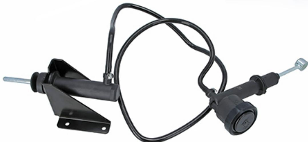
Quando o pedal da embreagem é acionado, o movimento do pistão faz com que a pressão se acumule no cilindro mestre da embreagem, que é passado através da linha hidráulica para o cilindro escravo. A partir daqui, a pressão é retransmitida para o mecanismo de liberação, que abre a embreagem e, assim, interrompe o fluxo de potência do motor para a transmissão.
