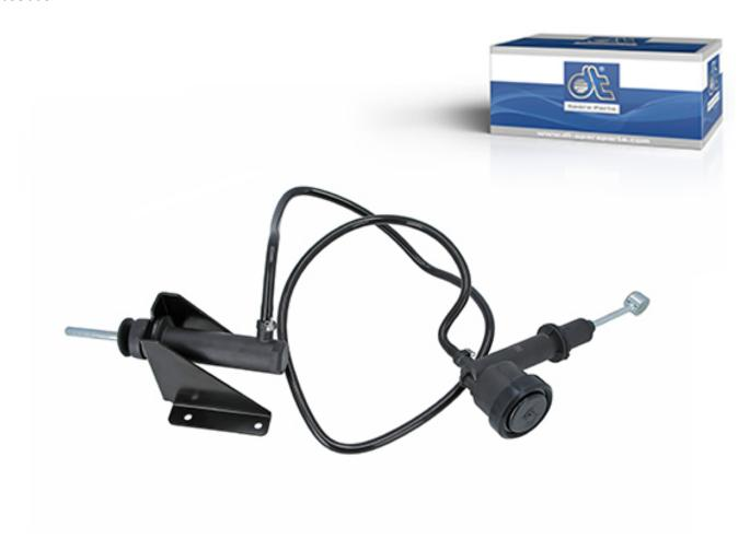
Quando o pedal da embreagem é acionado, o movimento do pistão faz com que a pressão se acumule no cilindro mestre da embreagem, que é passado através da linha hidráulica para o cilindro escravo. A partir daqui, a pressão é retransmitida para o mecanismo de liberação, que abre a embreagem e, assim, interrompe o fluxo de potência do motor para a transmissão.
