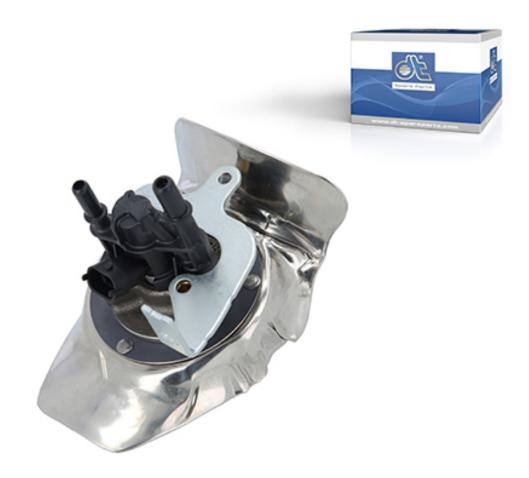
Como um componente importante do sistema de limpeza de gases de escape, que possibilita reduzir as emissões de óxido de azoto em até 90%, o módulo de dosagem injeta individualmente a mistura água-ureia de forma comprimida no sistema de escape. A quantidade injetada depende da rotação do motor e da carga do veículo.
