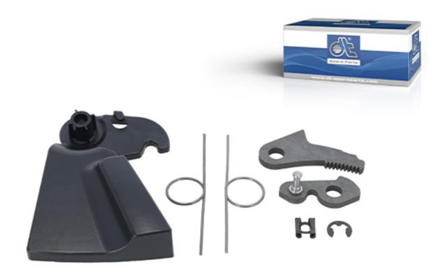
Este item é um kit de reparo do assento esquerdo, adequado tanto para volante à esquerda quanto para volante à direita. Serve para variar a posição do encosto.
