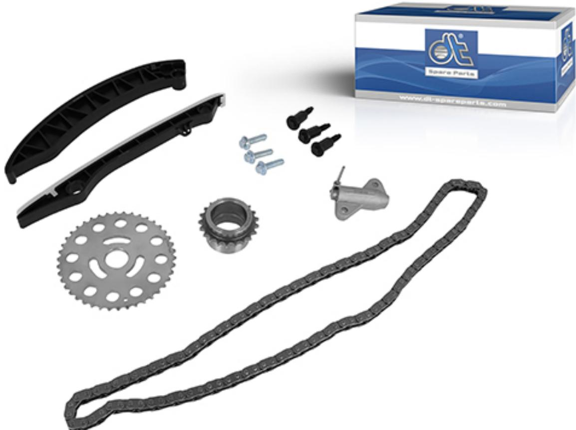
A corrente de distribuição está localizada na frente do motor e é montada em duas rodas dentadas - no virabrequim e no eixo de comando de válvulas. A corrente de distribuição transmite o movimento de rotação do virabrequim para o eixo de comando, o que garante que as válvulas abram e fechem no momento certo.
