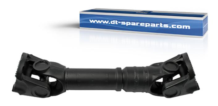
O eixo de transmissão, também conhecido como eixo cardan, é um componente importante na tração traseira e das quatro rodas. Seu trabalho é transferir o torque em um trem de acionamento afivelado do motor ou da unidade de transmissão para o diferencial do eixo. O eixo de acionamento possui juntas universais para que o motor e o eixo não sejam conectados rigidamente, sem suspensão. Assim, garante a mobilidade durante o deslocamento normal e compensa as diferenças de altura.
