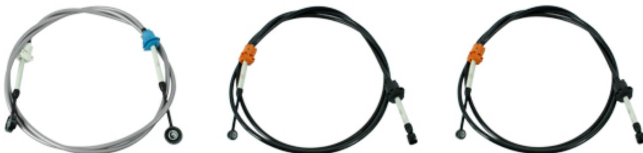
Os cabos de acionamento para caixa de câmbios transmitem o movimento da alavanca para a caixa de câmbio. Assim que o motorista engata ou troca de marcha, os cabos entram em funcionamento e transmitem este impulso mecânico para a caixa de câmbio. Graças a estes cabos, as forças de tração de até 7 kN (Kilo-Newton) são transportadas a uma distância de até mais de 4 metros.
