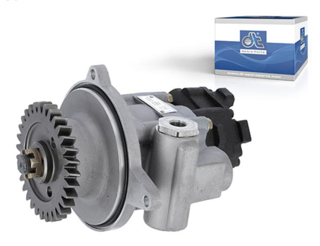
A bomba da direção assistida 2.53183 bombeia o óleo hidráulico necessário para facilitar a direção do veículo e o leva até à caixa de direção. A engrenagem integrada garante um funcionamento suave e que a bomba de combustível conectada com tandem-design envie o combustível do tanque para a bomba de injeção.
