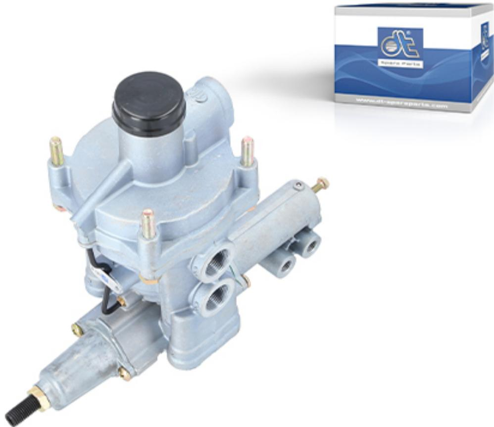
Il sistema di regolazione automatica della forza frenante in funzione del carico consente di regolare l'effetto della frenata del camion in base alle condizioni di carico del veicolo. In caso di carico pesante, la potenza dei freni viene aumentata; in caso di carico leggero, viene invece ridotta. Questo sistema riduce l'usura non necessaria ed elimina il rischio di blocco delle ruote.
