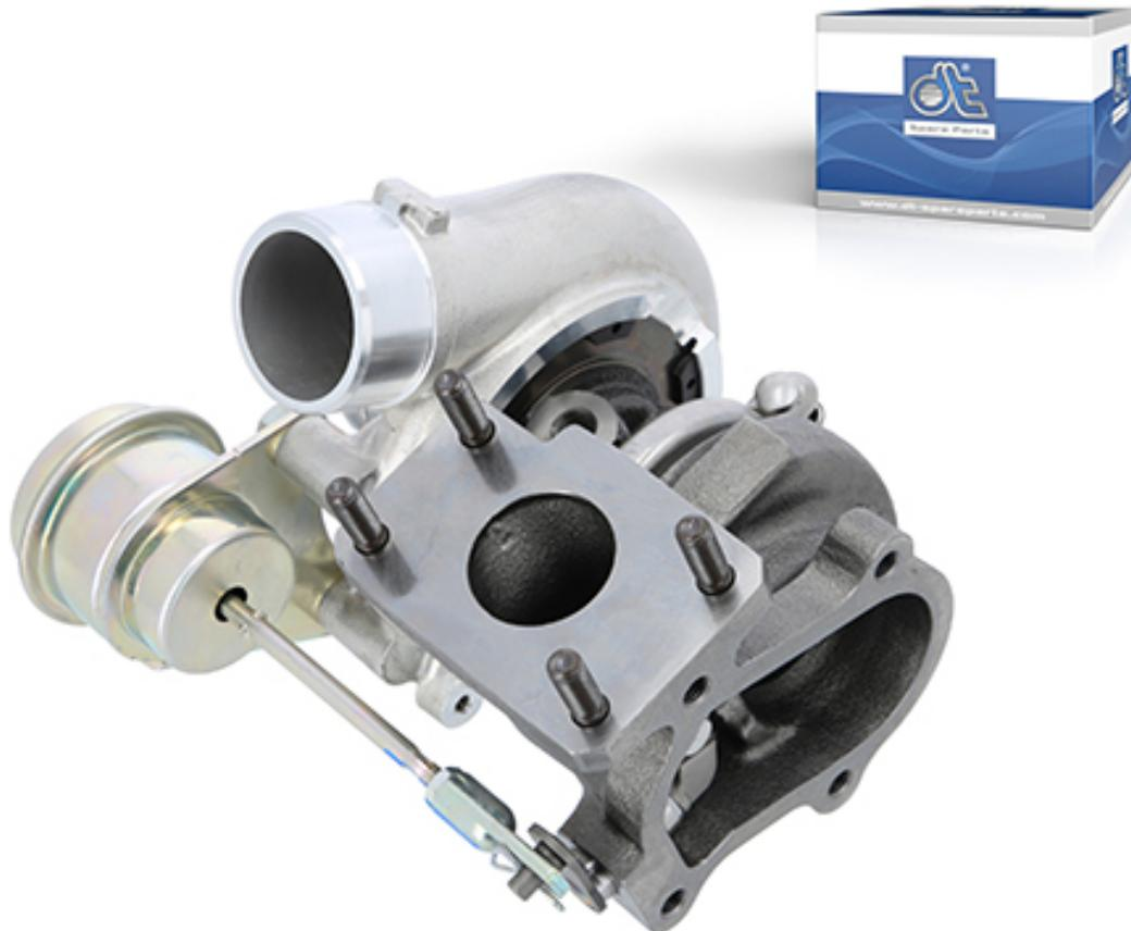
I turbocompressori di scarico sono costituiti da due macchine a flusso; una turbina e un compressore che sono posizionati su un albero di giunzione. Il compressore aspira aria fresca, che viene prima pressata attraverso il refrigeratore dell'aria di ricarica per il raffreddamento e poi portata fino a 2 bar nella camera di combustione.
