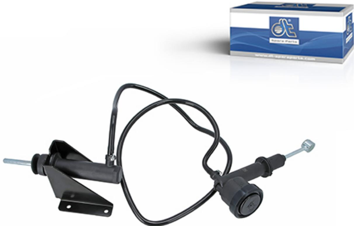
Quando si aziona il pedale della frizione, il movimento del pistone genera un aumento della pressione nel cilindro master della pompa frizione, che attraversa la linea idraulica verso il cilindro attuatore. Da qui, la pressione viene trasmessa al cuscinetto disinnesto, il quale stacca la frizione e ciò arresta il flusso di potenza dal motore alla trasmissione.
