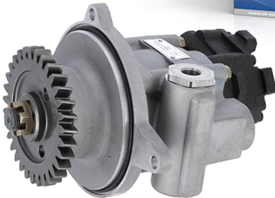
La pompa servosterzo 2.53183 eroga l'olio idraulico richiesto dall'ingranaggio dello sterzo per agevolare la sterzata del veicolo. L'ingranaggio integrato assicura che la trasmissione funzioni senza intoppi e la pompa tandem del carburante fornisca il carburante dal serbatoio alla pompa di iniezione.
