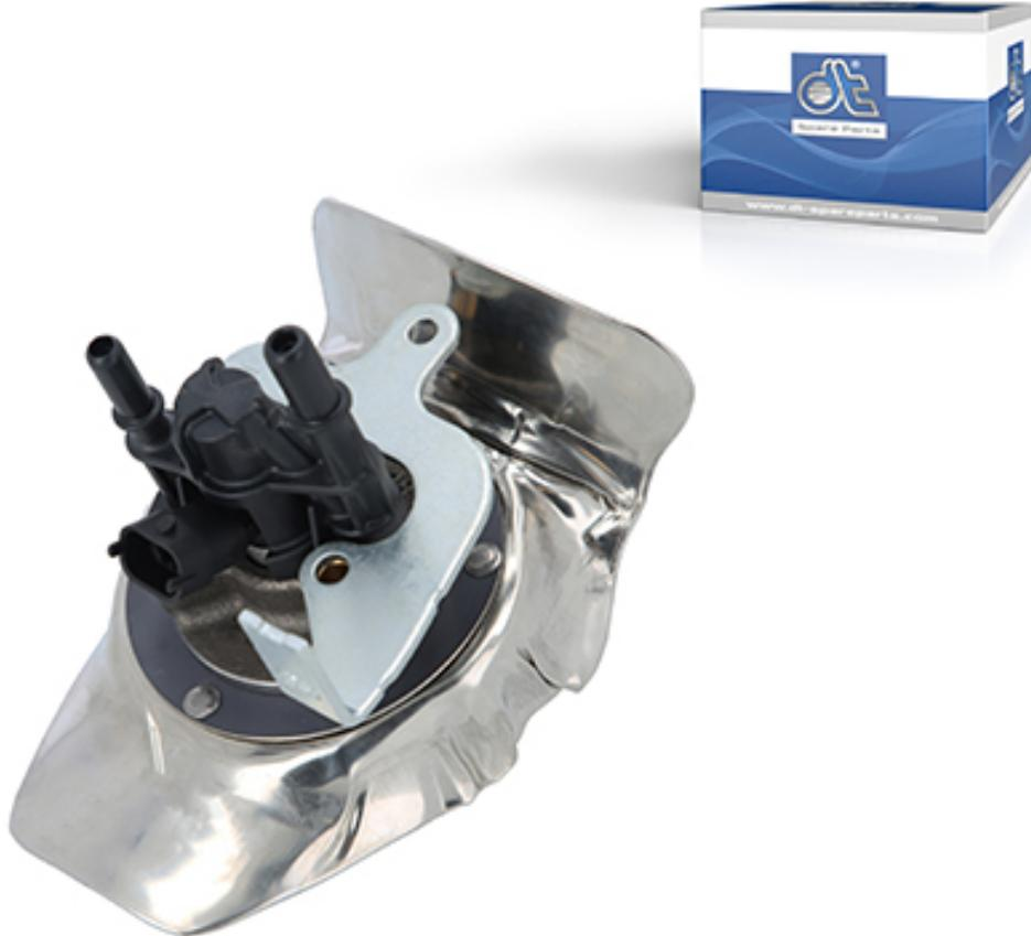
Il modulo dosatore, importante componente del sistema di pulizia dei gas di scarico che consente una riduzione fino al 90% delle emissioni di ossidi di azoto, inietta individualmente la miscela di acqua e urea in forma compressa nel sistema di scarico. La quantità iniettata dipende dalla velocità del motore e dal carico del veicolo.
