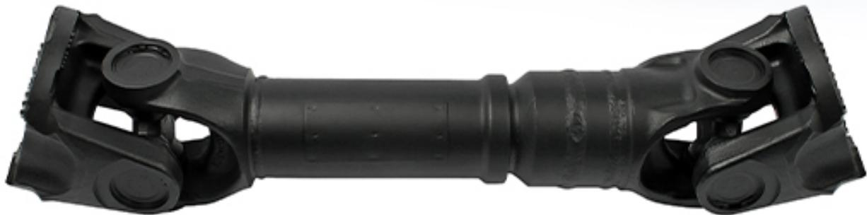
L'albero di trasmissione, anche noto come albero cardanico, è un componente importante nella trazione posteriore e integrale. Il suo compito è trasferire la coppia in un gruppo di trasmissione dal motore o dall'unità di trasmissione al differenziale dell'assale. L'albero di trasmissione ha dei giunti universali che fanno sì che il motore e l'assale non siano collegati rigidamente. Assicura così la mobilità durante la guida normale e compensa le differenze in altezza.
