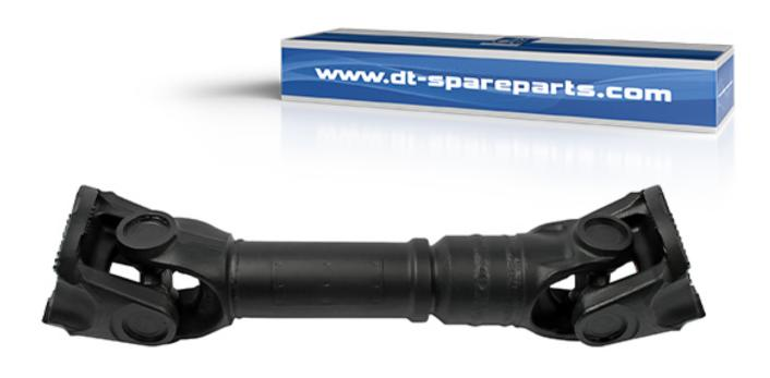
L'albero di trasmissione, anche noto come albero cardanico, è un componente importante nella trazione posteriore e integrale. Il suo compito è trasferire la coppia in un gruppo di trasmissione dal motore o dall'unità di trasmissione al differenziale dell'assale. L'albero di trasmissione ha dei giunti universali che fanno sì che il motore e l'assale non siano collegati rigidamente. Assicura così la mobilità durante la guida normale e compensa le differenze in altezza.
