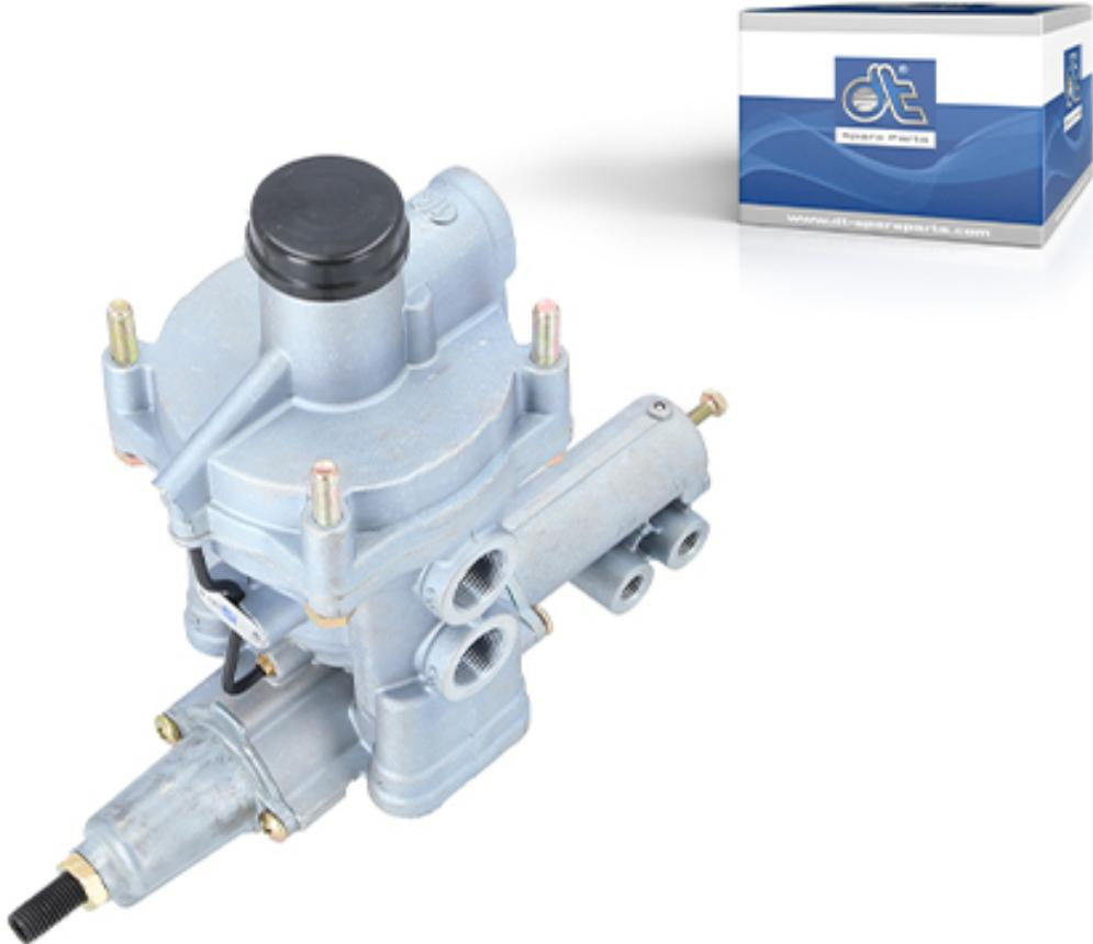
Le rôle du régulateur automatique de freinage en fonction de la charge est d'adapter l'effet de freinage d'un poids lourd à l'état de charge du véhicule. Avec une charge importante, les freins sont davantage sollicités et avec une charge moindre, l'effet de freinage est réduit. Cela diminue l'usure inutile et empêche les roues de se bloquer.
