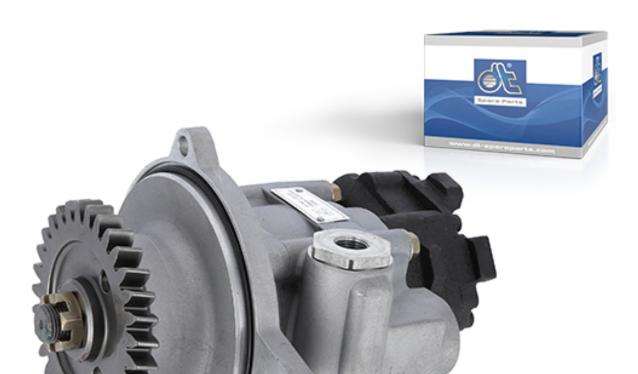
La pompe de direction assistée 2.53183 génère l'huile hydraulique nécessaire à une conduite aisée du véhicule et en alimente le boîtier de direction. L'engrenage intégré assure le bon fonctionnement de l'entraînement et la pompe à carburant de conception tandem connectée achemine le carburant du réservoir à la pompe à injection.
