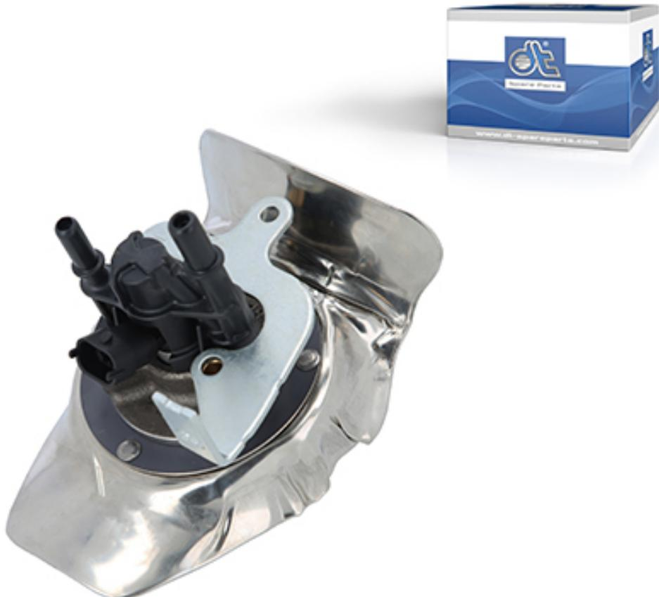
En tant que composant important du système de dépollution des gaz d'échappement, qui permet de réduire les émissions d'oxyde d'azote jusqu'à 90 %, le module de dosage injecte individuellement le mélange eau-urée sous forme comprimée dans le système d'échappement. La quantité injectée dépend du régime moteur et de la charge du véhicule.
