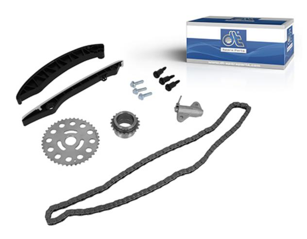
La chaîne de distribution est située à l'avant du moteur et est montée sur deux pignons ; sur le vilebrequin et sur l'arbre à cames. La chaîne de distribution transmet le mouvement rotatif du vilebrequin à l'arbre à cames, ce qui garantit que les soupapes s'ouvrent et se ferment au bon moment.
