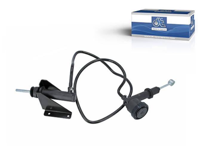
Lorsque la pédale d'embrayage est actionnée, le mouvement du piston provoque une accumulation de pression dans le maître cylindre de l'embrayage, qui passe par la conduite hydraulique vers le cylindre récepteur. De là, la pression est relayée au mécanisme de débrayage, qui ouvre l'embrayage et interrompt ainsi le flux de puissance du moteur à la transmission.
