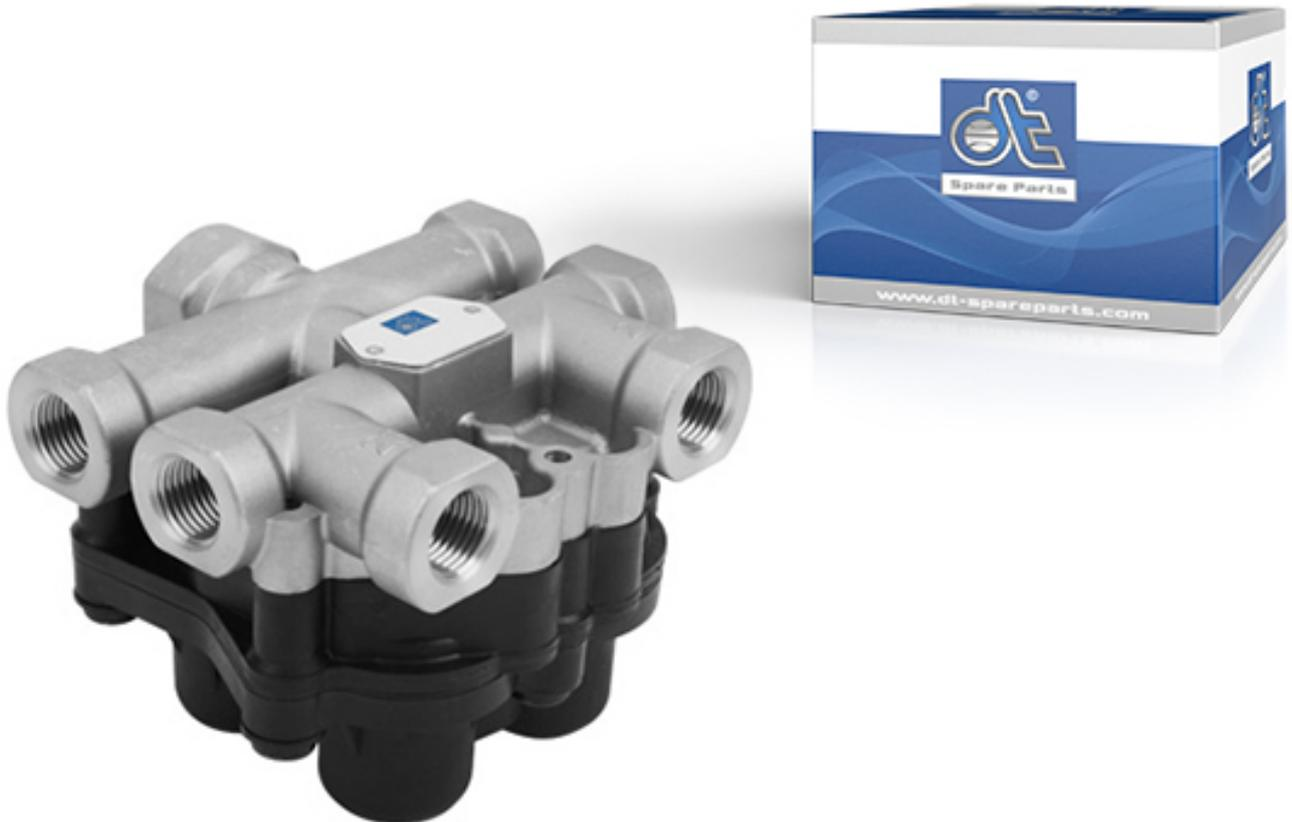
La válvula de protección de 4 vías protege cada uno de los circuitos del sistema de frenado neumático entre sí, garantizando una protección de presión de los circuitos de frenado intactos, si, en el caso de una caída de presión, uno o más circuitos de frenado fallasen. De este modo, se impide un fallo total de los frenos.
