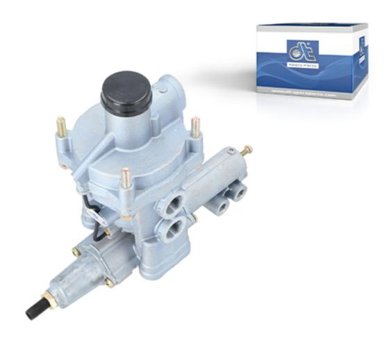
Como su propio nombre indica, la válvula reguladora automática de frenado según carga tiene la función de hacer que el efecto de frenado de un camión varíe dependiendo de la carga del vehículo. Con una carga pesada, los frenos ejercerán más fuerza y con menos carga, el efecto de frenado se reducirá. Esto evitará un desgaste innecesario y que las ruedas se bloqueen.
