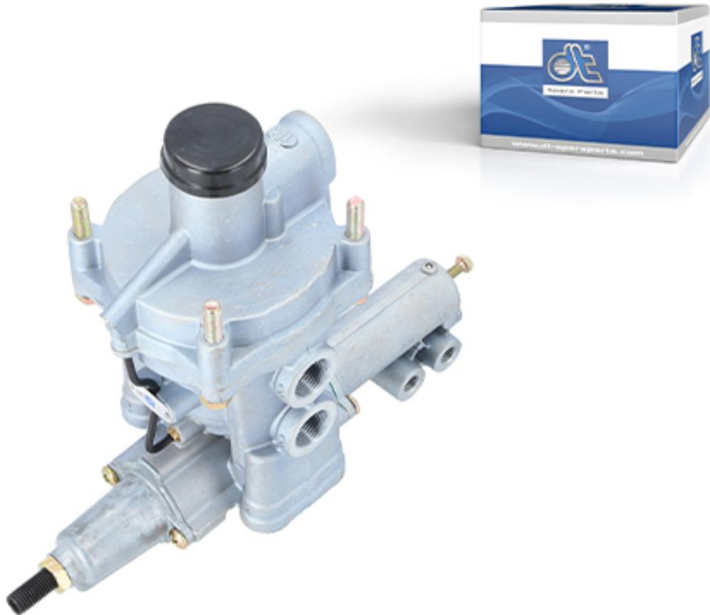
Como su propio nombre indica, la válvula reguladora automática de frenado según carga tiene la función de hacer que el efecto de frenado de un camión varíe dependiendo de la carga del vehículo. Con una carga pesada, los frenos ejercerán más fuerza y con menos carga, el efecto de frenado se reducirá. Esto evitara un desgaste innecesario y que las ruedas se bloqueen.
