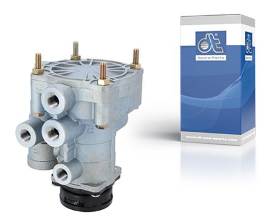
La válvula de control en la tractora se encarga de regular el aire comprimido que llega al sistema de frenos del semirremolque. También controla el sistema de frenado del remolque a través del sistema de freno de servicio de la tractora y a través de la válvula de estacionamiento y la válvula auxiliar de frenado.
