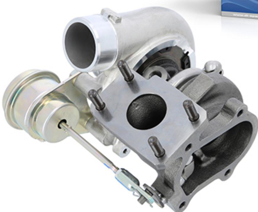
Los turbocompresores se componen de una turbina y un compresor, ambos colocados en un mismo eje coaxial. El compresor succiona aire a presión atmosférica, y rápidamente lo comprime y enfriá mediante el enfriador de aire hasta hacerlo llegar a la cámara de combustión con una presión de 2 bares.
