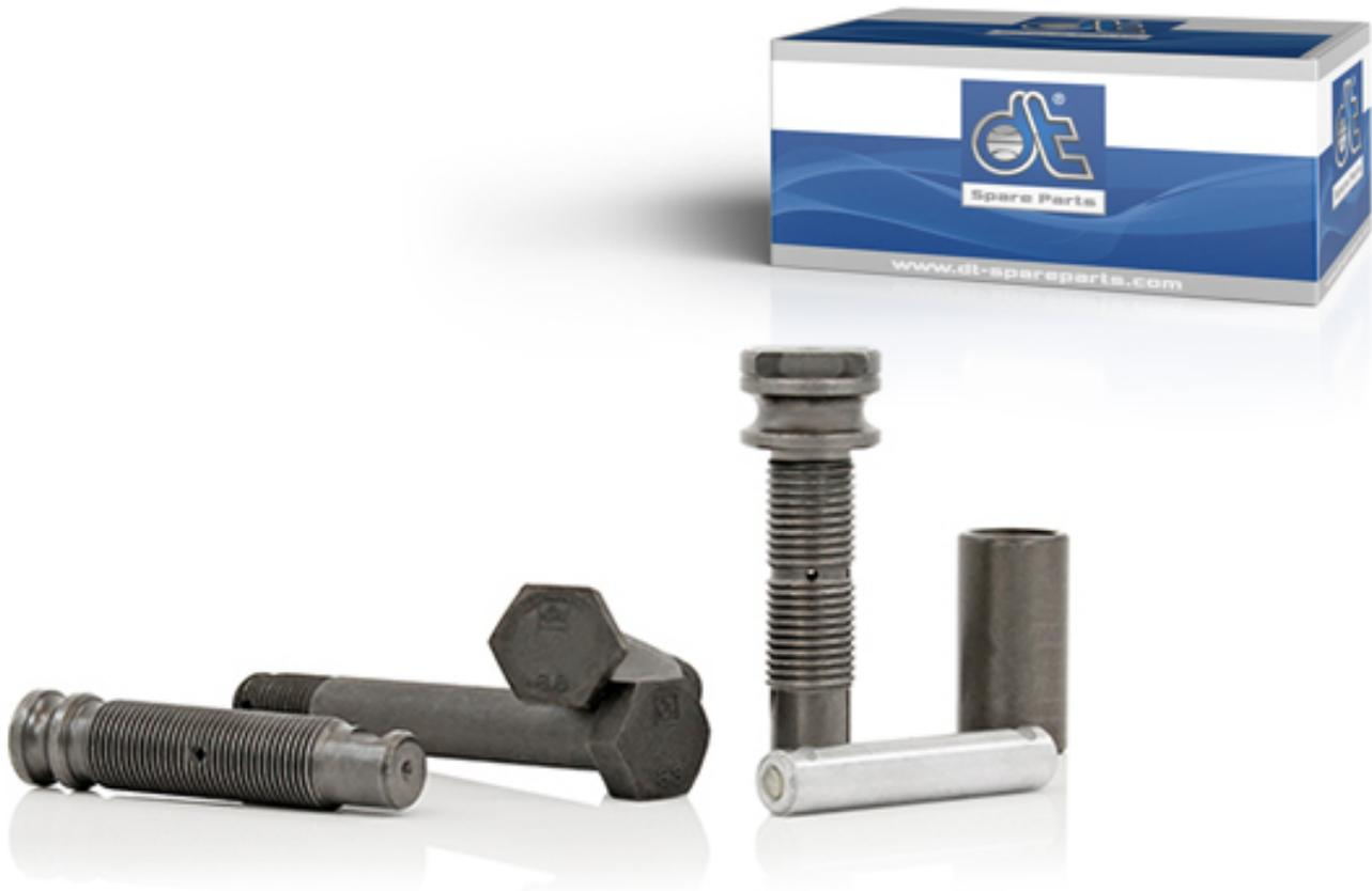
Los pernos de ballesta son componentes relevantes para la seguridad que junto con el casquillo sirven para unir la ballesta al soporte del bastidor. Los elementos de conexión de alta resistencia se encuentran disponibles en diversas ejecuciones geométricas en función del uso, campo de aplicación o necesidades. Se utilizan diversos tipos constructivos en función del diseño de la ballesta y del casquillo de resorte correspondiente.
