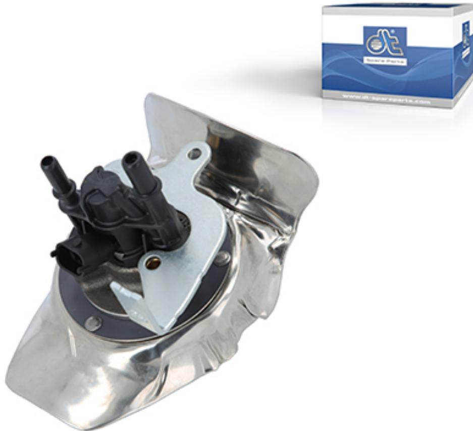
Como componente importante del sistema de limpieza de los gases de escape, que permite reducir las emisiones de óxido de nitrógeno hasta en un 90 %, el módulo de dosificación inyecta individualmente la mezcla de agua y urea de forma comprimida en el sistema de escape. La cantidad inyectada dependerá de la velocidad del motor y la carga del vehículo.
