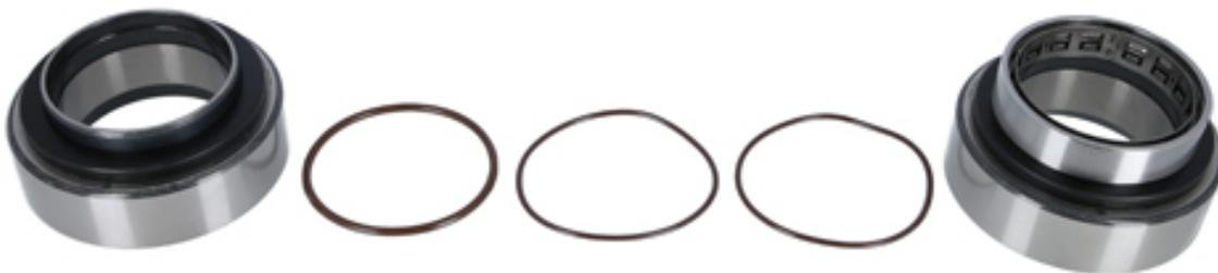
Los rodamientos sostienen y guían a los ejes y ruedas, lo que permite que estas giren fácilmente y con escasa fricción sobre ellos. Los rodamientos absorben las fuerzas radiales y/o axiales de las ruedas causadas por la conducción, el frenado y las curvas.
