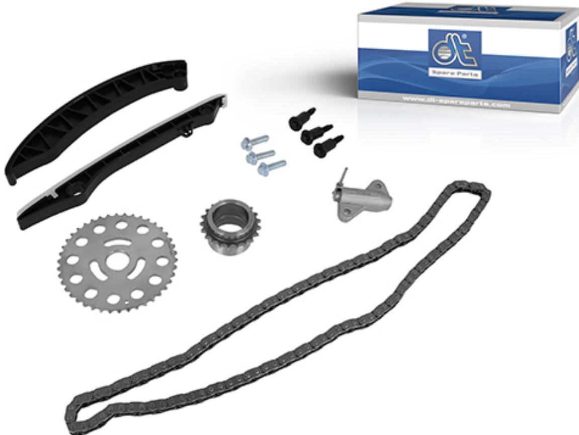
La cadena de distribución está en la parte delantera del motor y va montada sobre dos piñones, en el cigüeñal y en el árbol de levas. La cadena de distribución transmite el movimiento rotatorio del cigüeñal al árbol de levas, lo que permite que las válvulas se abran y se cierran en el momento adecuado.
