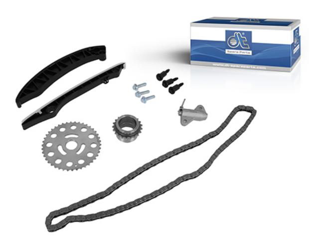
La cadena de distribución está en la parte delantera del motor y va montada sobre dos piñones, en el cigüeñal y en el árbol de levas. La cadena de distribución transmite el movimiento rotatorio del cigüeñal al árbol de levas, lo que permite que las válvulas se abran y se cierran en el momento adecuado.
