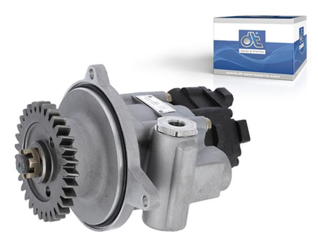
La bomba de servodirección 2.53183 genera la suficiente presión del aceite hidráulico para manejar cómodamente la dirección del vehículo. El engranaje integrado garantiza que la transmisión funciona suavemente y que la bomba tándem conectada suministra el combustible desde el depósito hasta la bomba de inyección.
