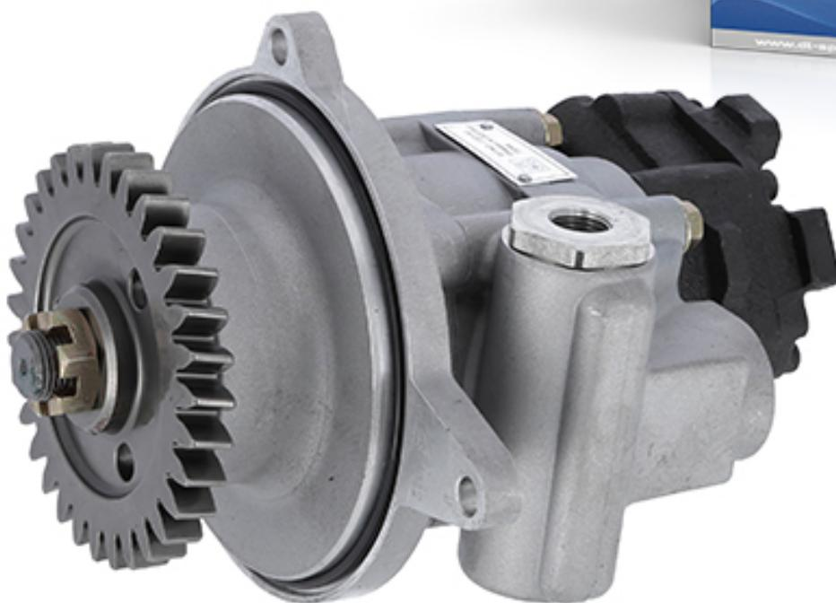
La bomba de servodirección 2.53183 genera la suficiente presión del aceite hidráulico para manejar cómodamente la dirección del vehículo. El engranaje integrado garantiza que la transmisión funciona suavemente y que la bomba tandem conectada suministra el combustible desde el depósito hasta la bomba de inyección.
