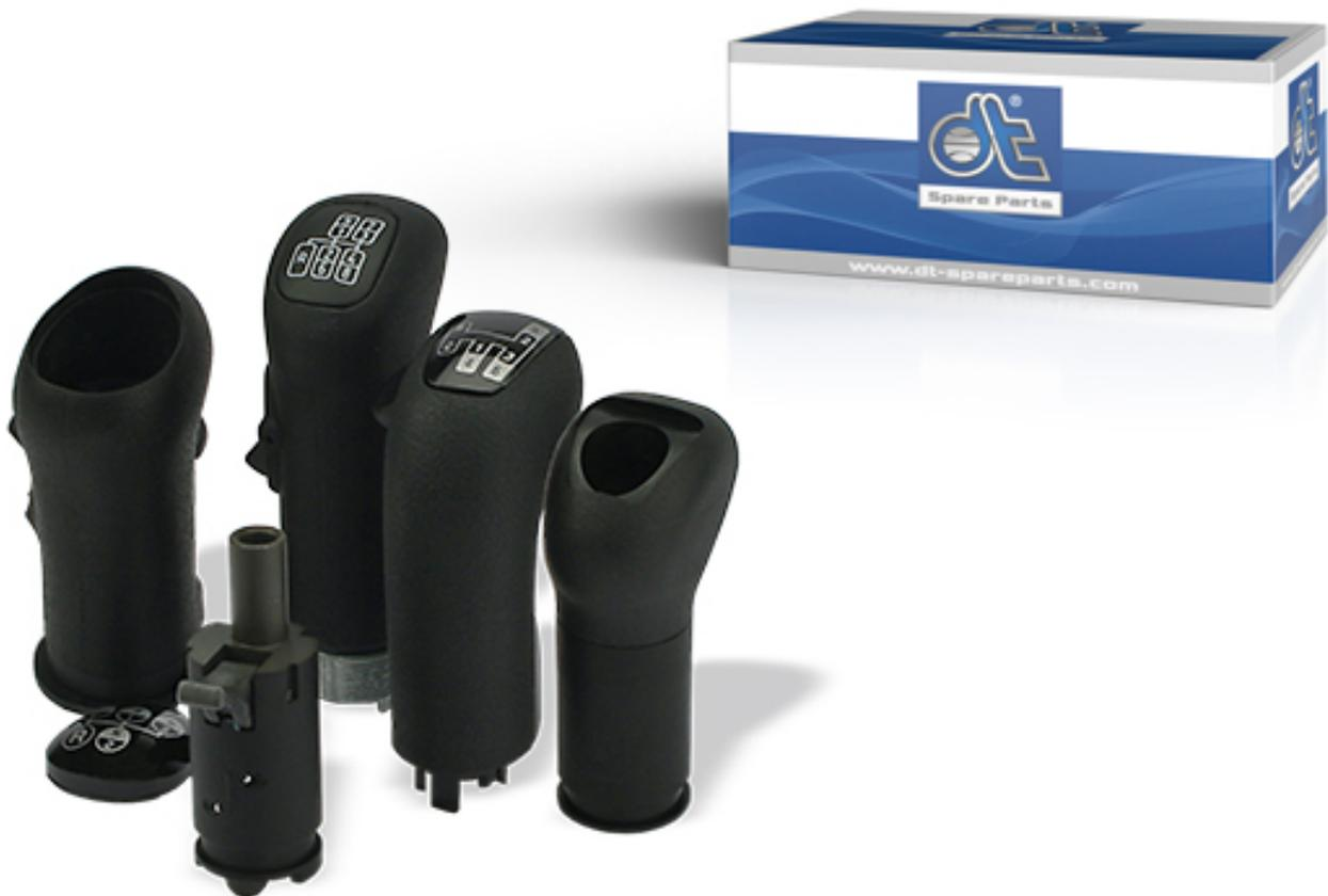
Schaltknäufe der Marke DT® arbeiten je nach Bauart, pneumatisch oder elektrisch. Die pneumatischen Schaltknäufe sind mit langlebigen Druckluftschläuchen versehen, die für Polyamidrohre nach DIN 74324 mit einem Durchmesser von 4 mm geeignet sind.
