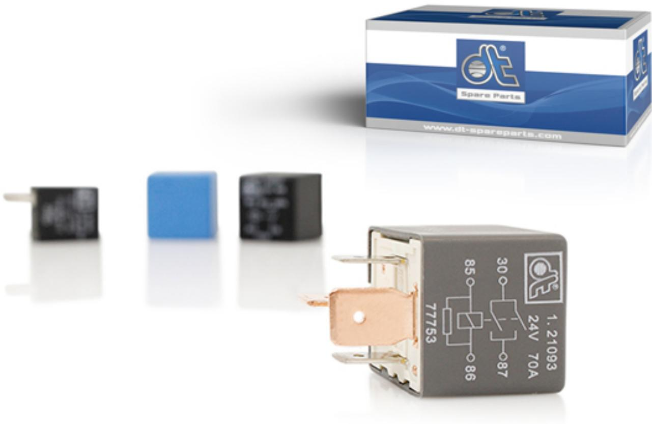
Relais dienen zur Trennung von Stromkreisen und zum Schalten elektrischer Verbraucher bis zu einer Stromstärke von 70 Ampere. Die Vorteile von Relais sind die kompakte Bauform und die Möglichkeit, mit kleinen Strömen große elektrische Verbraucher schalten zu können. Außerdem bieten Relais bieten die Möglichkeit, mit geringen Steuerungsspannungen höhere Spannungen schalten zu können.
