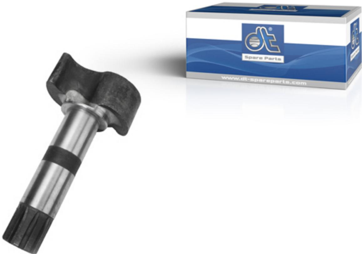
Bremsnockenwellen werden bei Simplex-Trommelbremsen eingesetzt. Sie dienen dazu, die durch den Druckluftbremszylinder erzeugte Kraft über einen Gestängesteller auf die beiden Bremsbacken zu übertragen.
