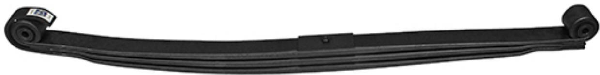
Die Blattfeder 4.67601 wird zweiseitig eingespannt und besteht aus einem flachen, bogenverspannten Profil. Generell sind Blattfedern die am wichtigsten biegebeanspruchten Federn und kommen häufig bei nicht luftgederten LKW-Starrachsen vor und übernehmen zusätzlich die Aufgabe der Radführung. Die Blätter bestehen aus mehreren Lagen, wodurch beim Federn durch Reibung eine Eigendämpfung entsteht. Verbunden werden diese von Herzbolzen, Federbund und Spannplatten.
