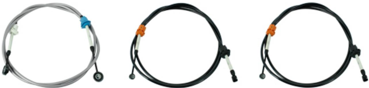
Les flexibles d'embrayage transfèrent les forces du levier de vitesse vers la transmission. Dès que le conducteur sélectionne ou change une vitesse, le câble transmet cette impulsion mécanique à la transmission. Des forces de traction allant jusqu'à 7 kiloNewton sont transmises sur des distances qui dépassent parfois 4 mètres.
