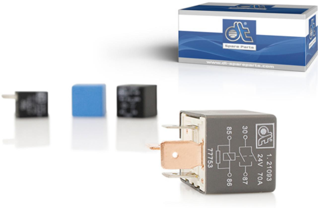
Los relés se utilizan para separar los circuitos eléctricos y para conmutar componentes eléctricos con una corriente de hasta 70 amperios. Las ventajas de los relés son su forma compacta y la posibilidad de conmutar con pequeñas corrientes grandes componentes eléctricos. Además, los relés ofrecen la posibilidad de conmutar voltajes más altos con bajas tensiones de control.
