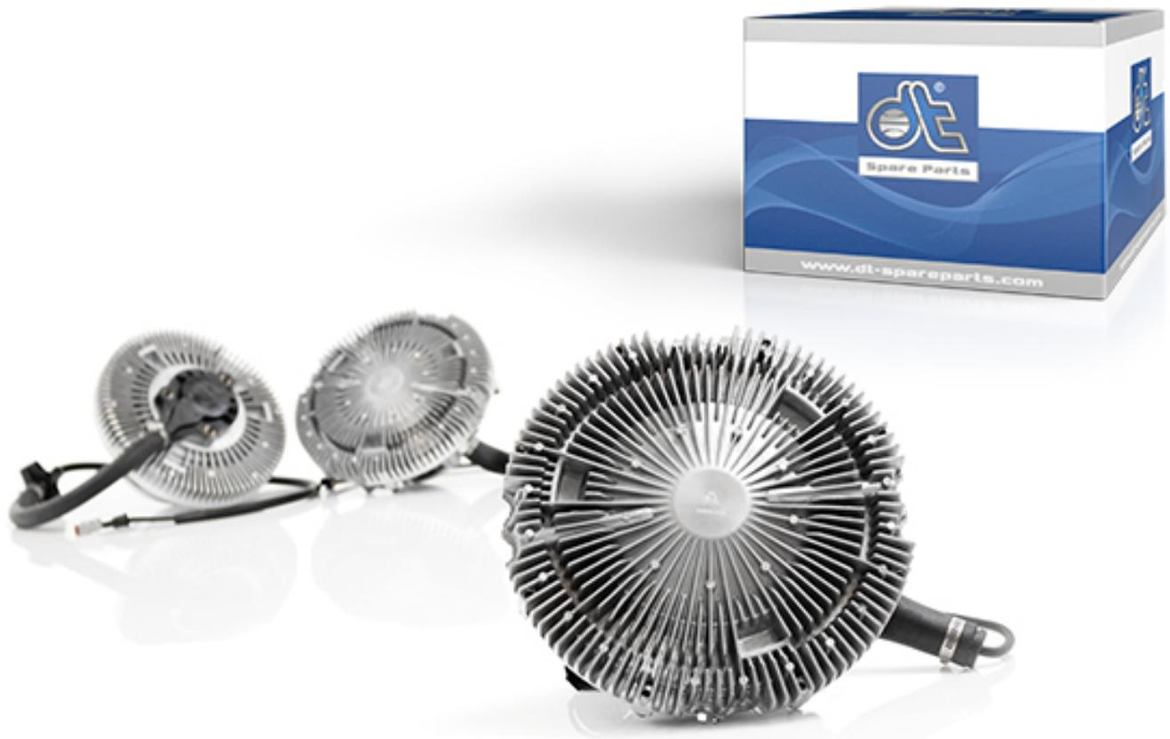
Los embragues electrónicos de ventilador se utilizan en motores instalados longitudinalmente. Se instalan en la dirección de marcha delante del refrigerador, y son accionados mediante correas o directamente por el motor.
