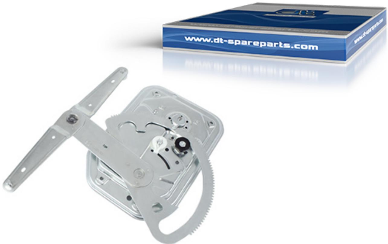
Los eevalunas sirven para subir y bajar los cristales de las ventanas y permiten mantenerlos en cualquier posición. Los vehículos más antiguos llevan instalados eevalunas mecánicas accionados mediante una manivela. Los vehículos modernos utilizan cada vez más eevalunas eléctricos que se accionan mediante un motor eléctrico. Estos eevalunas se controlan de manera independiente mediante un botón en el panel de instrumentos de la cabina.
