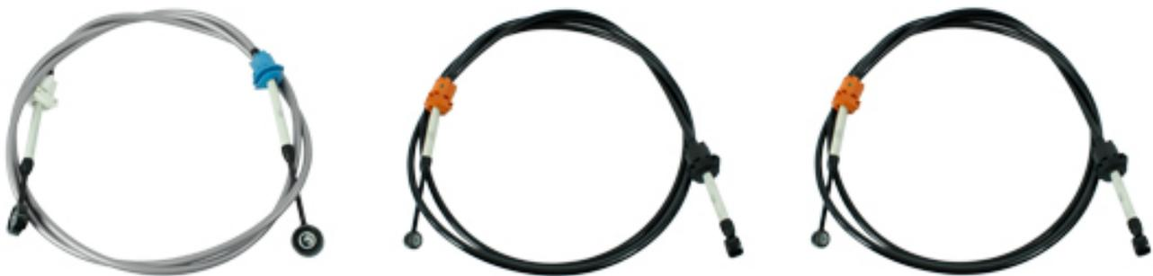
Los cables de accionamiento para caja de cambios transmiten el movimiento de la palanca a la caja de cambios. Tan pronto como el conductor cambia de marcha, los cables entran en funcionamiento y transmiten este impulso mecánico a la caja de cambios. Gracias a estos cables, las fuerzas de tracción de hasta 7 kN (KiloNewton) se transmiten a distancias de más de cuatro metros.
