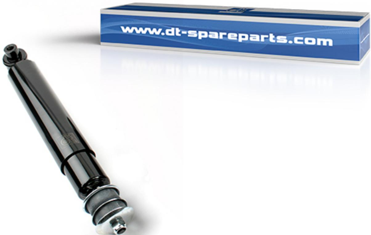
Los amortiguadores de chasis son de esencial importancia para la seguridad porque sirven para eliminar vibraciones del vehículo. Con los amortiguadores se absorben los choques que son canalizados al vehículo debido a desigualdades en la calzada. En el dimensionado de la amortiguación se busca el mejor término medio posible entre el confort (baja fuerza de amortiguación) y la seguridad en marcha (elevada fuerza de amortiguación).
