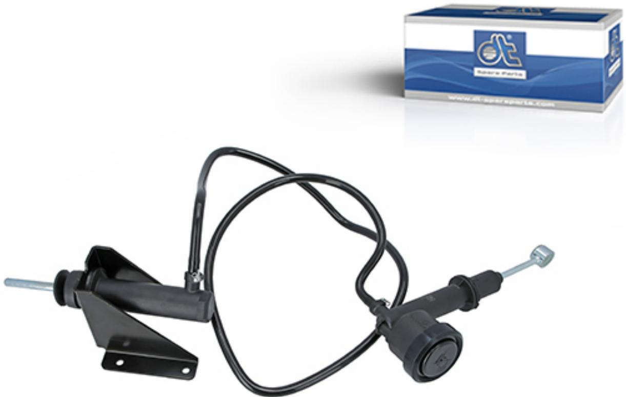
Durch die Betätigung des Kupplungspedals wird im Kupplungsgeberzylinder durch die Kolbenbewegung ein Druck aufgebaut, der durch die Hydraulikleitung zum Nehmerzylinder geleitet wird. Dieser gibt den Druck auf den Ausrücker weiter, welcher die Kupplung öffnet und den Kraftfluss vom Motor zum Getriebe damit unterbricht.
