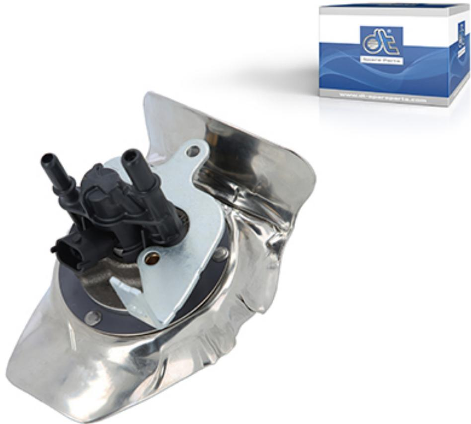
Als wichtiger Bestandteil des Abgasreinigungssystems, welches eine Reduzierung der Stickoxid-Emissionen um bis zu 90% ermöglicht, wird durch das Dosiermodul in verdichteter Form das Wasser-Harnstoff-Gemisch individuell in den Abgasstrang gesprüht. Die Einspritzmenge richtet sich nach Drehzahl und Fahrzeuglast.
